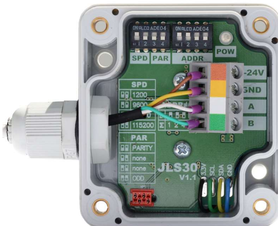
Рисунок 7 - Вид на JLS30HC со снятой крышкой
