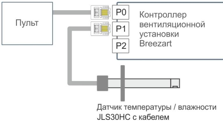
**Вариант 2.** Подключение к вентустановке двух цифровых датчиков температуры / влажности производится через кроссовый модуль RSCON-03 (можно подключать как к порту P1, так и к P2). При подключении к порту P2 дополнительно требуется блок питания 24В (этот порт не имеет питания). При подключении к порту P1 питание на RSCON можно подать от порта вентустановки.
