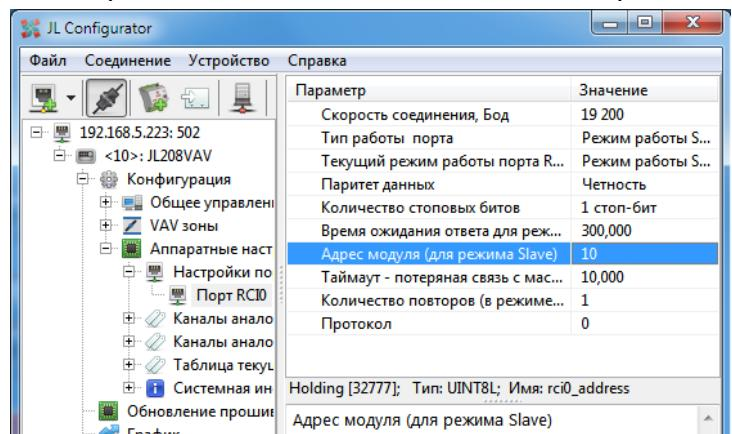
После сборки VAV системы в соответствии со схемой, настройте систему по инструкции [http://www.breezart.ru/tech/setting\\_vav\\_breezart.pdf](http://www.breezart.ru/tech/setting_vav_breezart.pdf)
