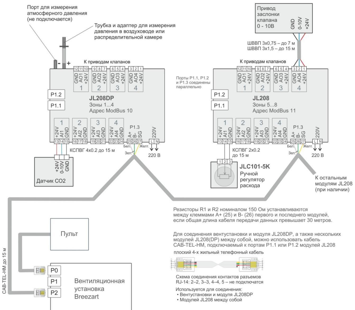
Тип и максимальная длина кабелей указаны на схеме, допускается использовать аналогичные кабели с таким же или большим сечением.
