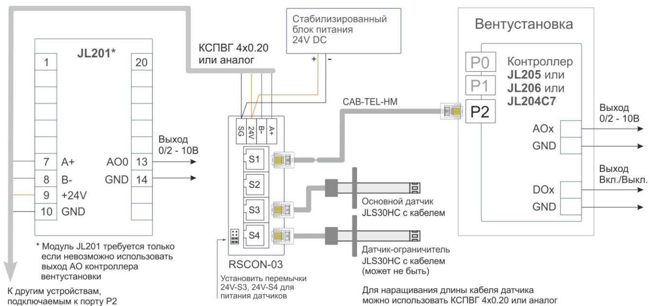
Для управления сигналом 0...10В (2...10В) можно использовать любой свободный выход АО контроллера вентустановки. Если все аналоговые выходы контроллера заняты, то к порту Р1 или Р2 можно подключить модуль JL201 и управлять увлажнителем через его выход АО0.
