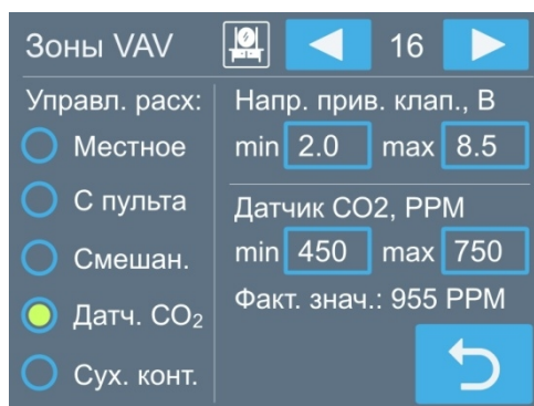
К модулю подключен датчик углекислого газа
