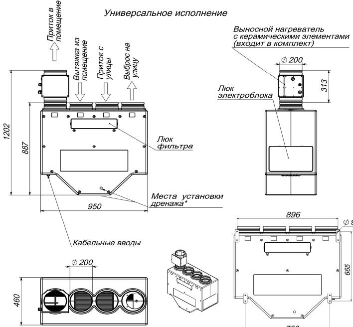
\* Комплект дренажа используется при влажности вытяжного воздуха выше 30%. Дренаж устанавливается в то из штатных отверстий, которое расположено в нижней точке оборудования
